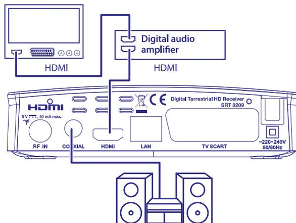
Connettendo il vostro ricevitore ad un amplificatore digitale o ad un sistema home cinema equipaggiato con una connessione HDMI potrete godere della miglior qualità sonora ed audio multicanale (se fornito dall'emittente). Connettere l'uscita HDMI del ricevitore all'ingresso dell'amplificatore e l'uscita HDMI dell'amplificatore con l'ingresso della TV. Selezionare la corretta impostazione sul vostro amplificatore per poter visualizzare ed ascoltare i programmi.
