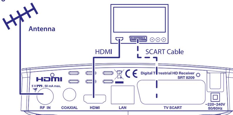
Il ricevitore é anche provvisto di un connettore SCART, in alternativa la TV può anche essere collegata al ricevitore tramite un cavo SCART di buona qualità.
