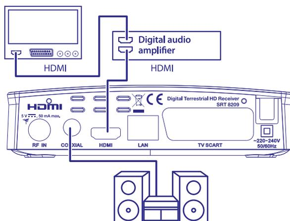
Connettendo il vostro ricevitore ad un amplificatore digitale o ad un sistema home cinema potrete godere della miglior qualità sonora ed audio multicanale (se fornito dall'emittente). Connetti il tuo Amplificatore Audio Digitale o sistema home cinema al connettore S/PDIF sul retro del ricevitore.
