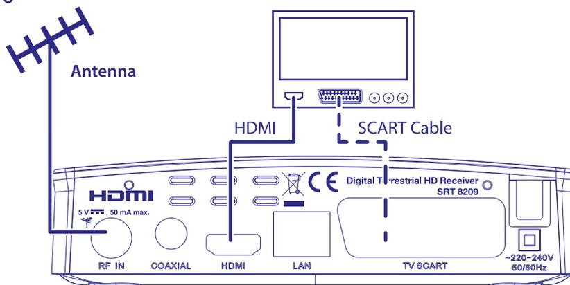
Per ricevere il segnale del digitale terrestre la vostra antenna interne o sterna deve essere collegata al connettore RF IN sulla parte posteriore del ricevitore. Si consiglia l'utilizzo di cavi antenna ben schermati e connettori appropriati.
