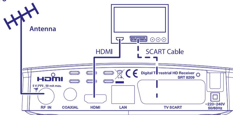
La TV deve essere collegata al ricevitore tramite un cavo HDMI di buona qualità. Questa connessione permette la qualità video migliore possibile.
