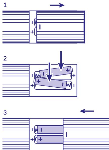
Öffnen Sie die Abdeckung der Fernbedienung und legen Sie zwei AAA-Batterien in das Fach ein. Die korrekte Position der Batterien ist im Batteriefach angegeben.
