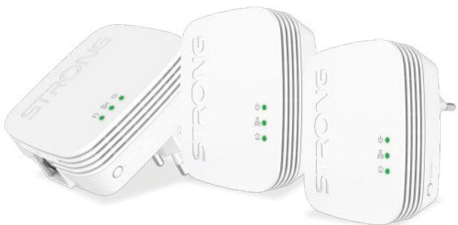
Ova mini verzija Powerline 600 će vam na iznimno jednostavan način pružiti kućnu mrežu velike brzine. Električni vodovi koriste postojeću električnu instalaciju vašeg doma brzinom do 600 Mbit/s. Ovaj komplet uključuje 3 adaptera.
