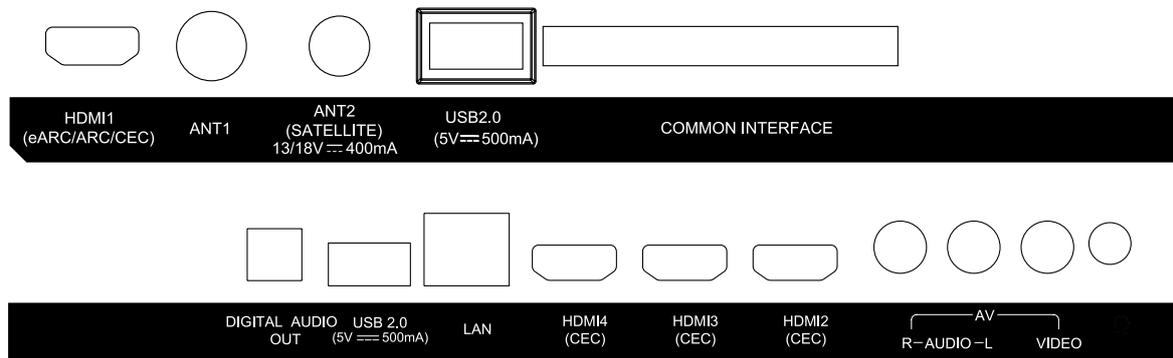
1. HDMI 1 (ARC) Zum Anschluss von Geräten mittels HDMI-Kabel, besonders geeignet für digitale A/V-Geräte (A/V- Receiver), die ARC (Audio Return Channel) unterstützen. Dieser Anschluss ermöglicht über die ARC Funktion die Wiedergabe bzw. Weiterleitung der Audiosignale und unterstützt Dolby Digital.
