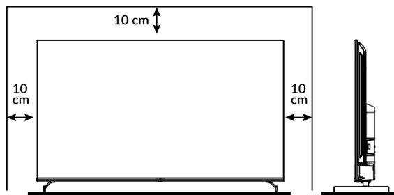
Positionieren Sie das Gerät auf einer geraden und ordentlich montierten, horizontalen Oberfläche wie einem Tisch, Wandregal oder TV-Möbel. Lassen Sie auf jeder Seite mindestens 10 cm Abstand zur Belüftung. Um jeden Fehler und gefährliche Situationen zu vermeiden, platzieren Sie keine Gegenstände auf dem Gerät. Dieser Fernseher kann in tropischen und / oder gemäßigten Klimazonen verwendet werden.
