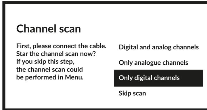
Der erste Schritt besteht darin, das Kabel anzuschließen. Dann müssen Sie den Sendersuchlauf starten. Sie können zwischen *digitale und analoge Kanäle*, *nur analoge Kanäle* oder *nur digitale Kanäle* wählen. Wenn Sie diesen Schritt überspringen, können Sie den Sendersuchlauf später durch Aufrufen des TV-Menüs durchführen. Drücken Sie **OK**, um Ihre Auswahl zu bestätigen.
