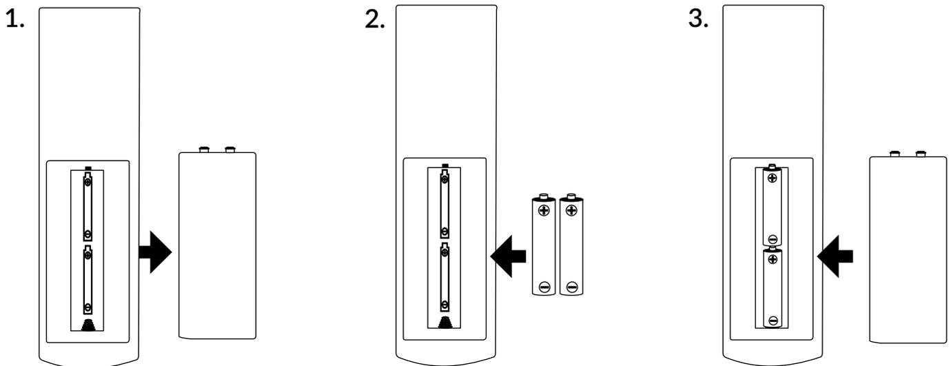
Legen Sie 2x AA-Batterien in das Batteriefach der kleineren Fernbedienung und 2x AAA im Batteriefach der größeren Fernbedienung. Stellen Sie sicher, dass die Batterien in korrekter Richtung eingelegt sind.
