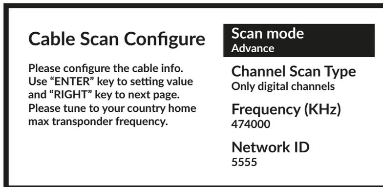
Im Menü *Scan-Modus* können Sie durch Auswahl von *Voll* einen vollständigen Suchlauf durchführen, während Sie durch Auswahl von *Vorwärts* einen Suchlauf mit den vom Betreiber bereitgestellten Frequenz- und Netzwerk-ID-Daten durchführen können. Verwenden Sie die Taste **OK**, um den Wert einzustellen und **▶**, um den Kanalsuchlauf zu starten.
