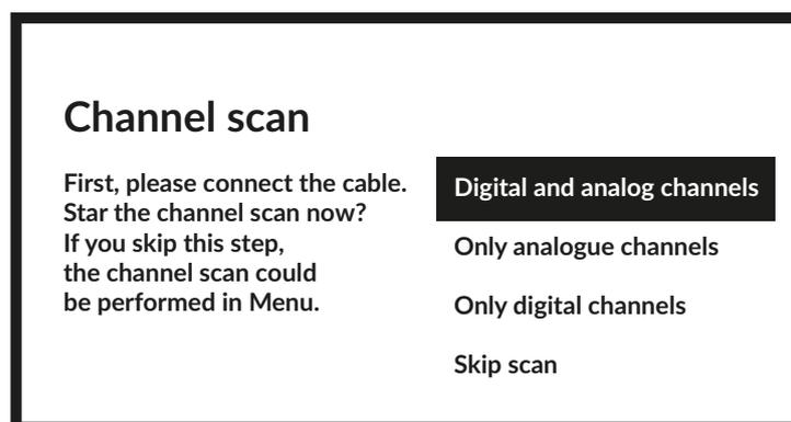
Der erste Schritt besteht darin, das Antennenkabel anzuschließen. Dann müssen Sie den Sendersuchlauf starten. Sie können zwischen *Digitale und analoge Kanäle*, *Nur analoge Kanäle* oder *Nur digitale Kanäle* wählen. Wenn Sie diesen Schritt überspringen, können Sie den Sendersuchlauf später durch Aufrufen des TV-Menüs durchführen. Drücken Sie **OK**, um Ihre Auswahl zu bestätigen.
