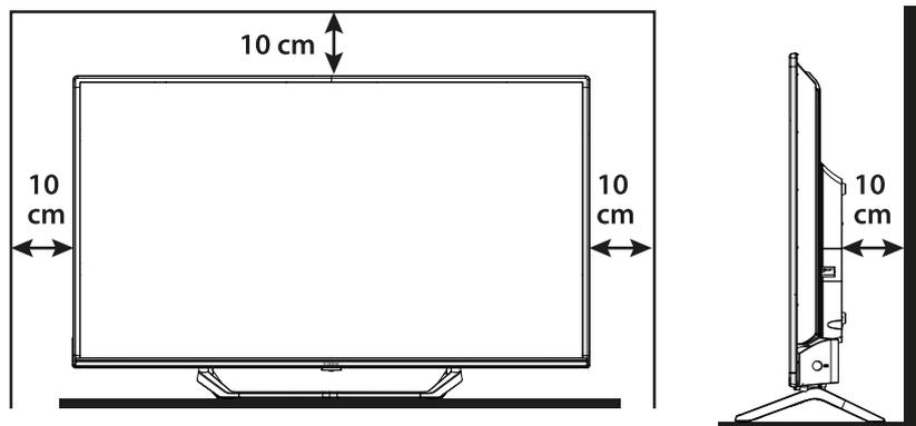
Installer l'écran sur une surface horizontale solide comme une table ou un bureau. Pour la ventilation, laissez un espace d'au moins 10 cm autour de l'appareil. Pour éviter toute situation dangereuse ou pouvant provoquer une panne, merci ne pas placer d'objets sur le dessus de l'appareil. Cet appareil peut être utilisé dans les climats tropicaux et/ou modérés.
