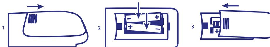
Coloque 2 pilhas AAA no compartimento das pilhas do telecomando mais pequeno. Certifique-se de que faz coincidir as polaridades das pilhas com as indicações no interior do compartimento.
