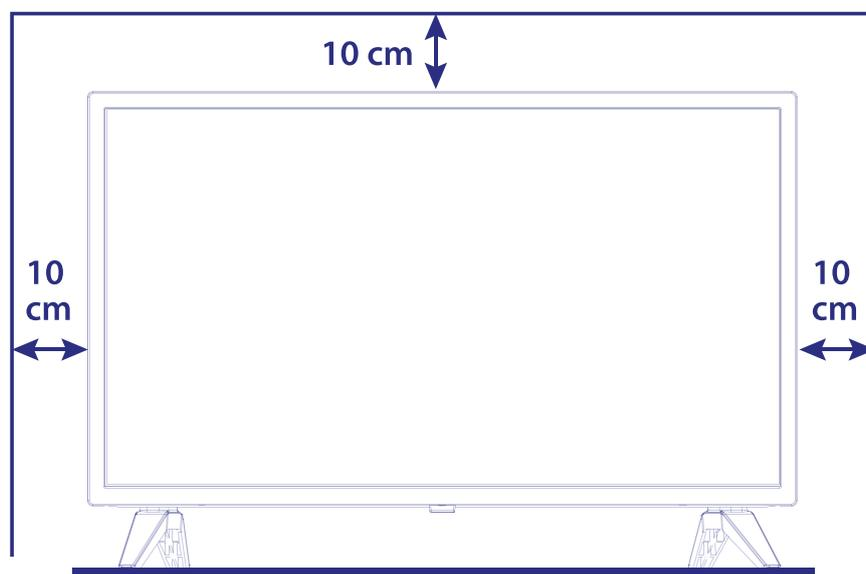
Instale o monitor sobre uma superfície sólida horizontal, como uma mesa ou escrivaninha. Para a ventilação, deixe um espaço de, pelo menos, 10 cm à volta do aparelho. Para evitar situações de falha e inseguras, por favor, não coloque nenhum objecto em cima do aparelho. Este aparelho pode ser usado em climas tropicais e/ou moderados.
